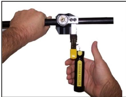
1. Sujete el cable con una mano; presione la palanca en la Banana Peeler y coloque la cuchilla en el punto de incisión deseado. La mordaza por resorte se cerrará, y la cuchilla penetrará la semiconductora precisamente a la profundidad establecida. Gire la herramienta alrededor de la circunferencia del cable. La cuchilla puntúa el revestimiento 360 grados. Retire la herramienta.
